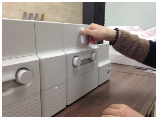
Рис. 147 Замена головки Ламинатора
