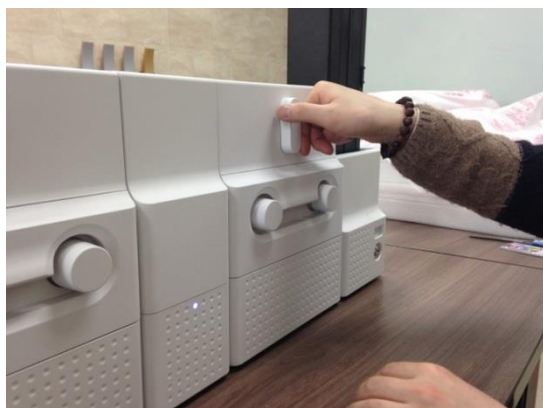
Рис. 117 Блокировка карты в Ламинаторе
