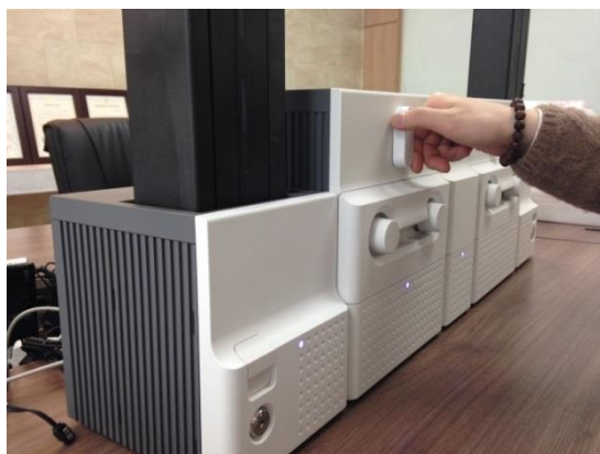
Рис. 141 Замена ТРН головки
