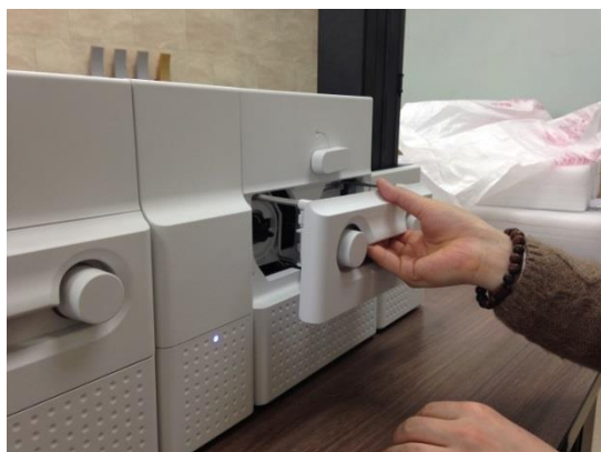
Рис. 148 Замена головки Ламинатора
