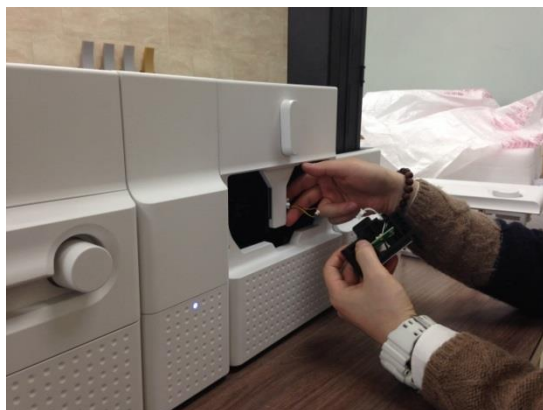
Рис. 151 Замена головки Ламинатора
