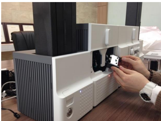
Рис. 144 Замена ТРН головки
