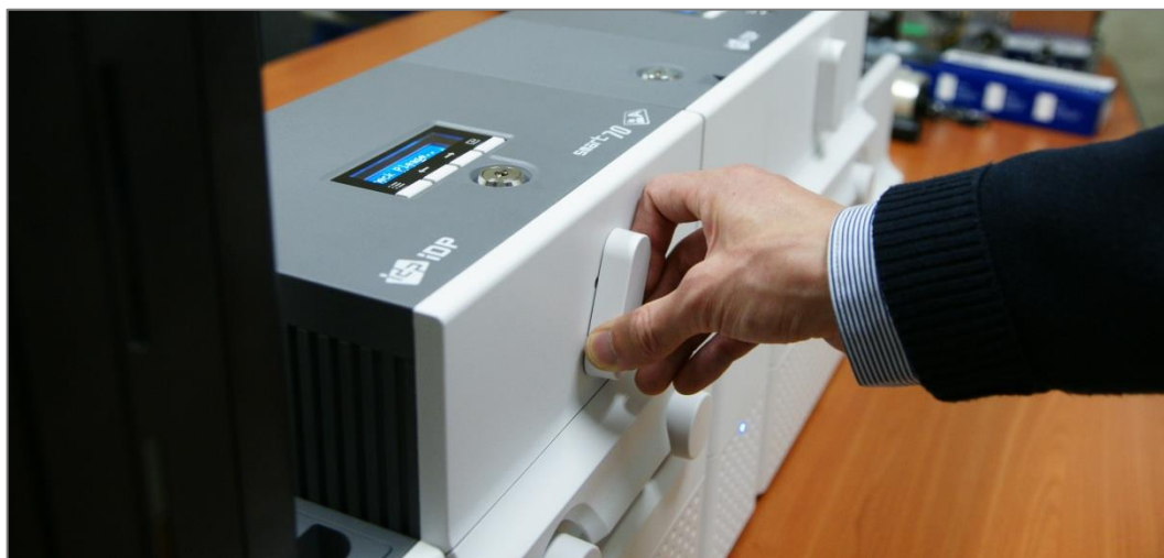
Рис. 26 Закрытие картриджа с Печатной / Ламинирующей лентой
