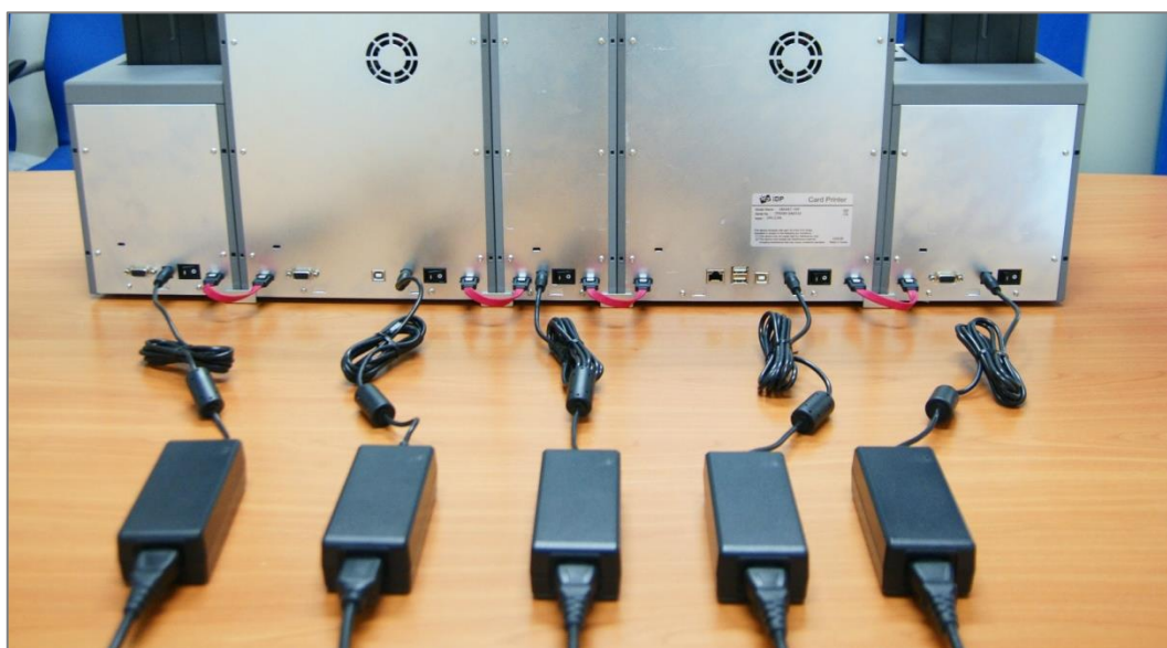
Рис. 57 Подключение кабелей ADVENT SOLID-700 IPPHLO
