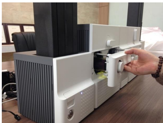
Рис. 142 Замена ТРН головки
