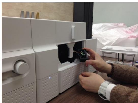
Рис. 150 Замена головки Ламинатора
