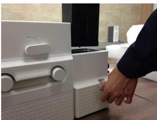
Рис. 139 Очистка Выходного лотка
