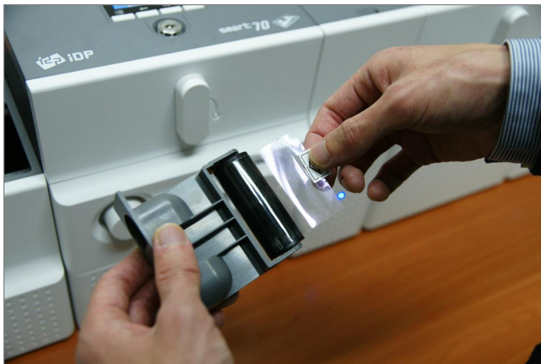
Рис. 30 Удаление защитной пленки с нового одноразового чистящего ролика
