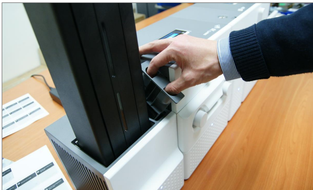
Рис. 27 Отсоединение держателя чистящего одноразового ролика.
