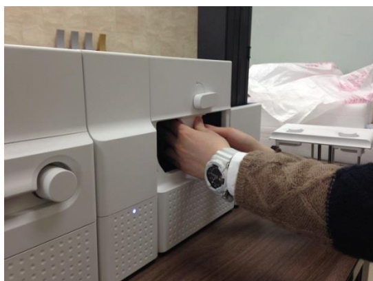
Рис. 149 Замена головки Ламинатора
