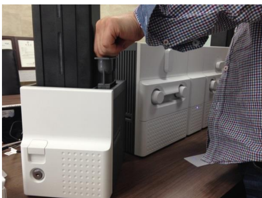
Рис. 127 Очистка Входного лотка
