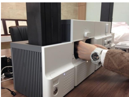
Рис. 146 Замена ТРН головки
