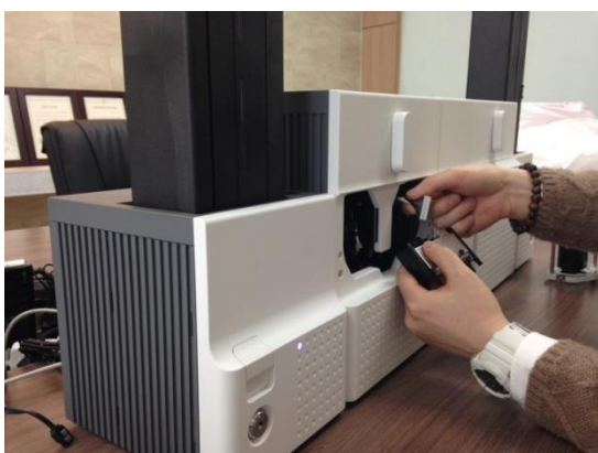
Рис. 145 Замена ТРН головки
