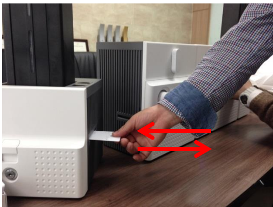
Рис. 106 Блокировка карт во Входном лотке
