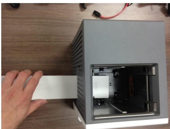
Рис. 140 Очистка Выходного лотка
